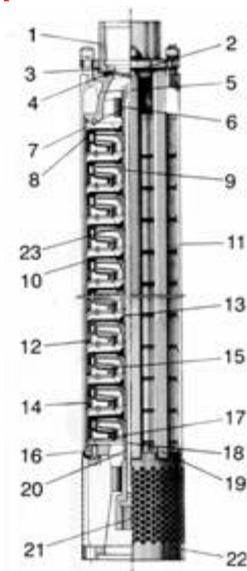
Электронасос предназначен для подачи питьевой воды из скважин общей минерализацией не более 1500 мг/л, рН от 6,5 до 9,5, с температурой до 25°C, с массовой долей твердых механических примесей не более 0,01 %. Электронасос может использоваться вне скважины при условии обеспечения необходимой скорости омывания корпуса электродвигателя перекачиваемой водой.
